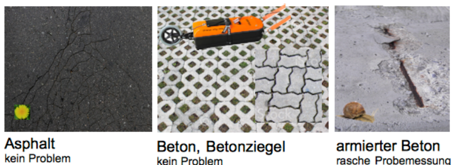
Abb. 12. Die Unterlage: Von vornherein gibt es keine Beschränkungen bei der Unterlage für die Messungen, wobei aber zu bedenken ist, dass es gute und weniger gute Unterlagen gibt, die die Energie-Ankopplung zwischen Antenne und Boden erheblich mitbestimmen können. Beim im Bild gezeigten stahlarmierten Beton hängen Erfolg oder "aussichtslos" von der Maschenweite der Armierung und der Frequenz der Antenne ab. Dafür gibt es keine Formel, aber eine Probemessung gibt rasch Auskunft.
