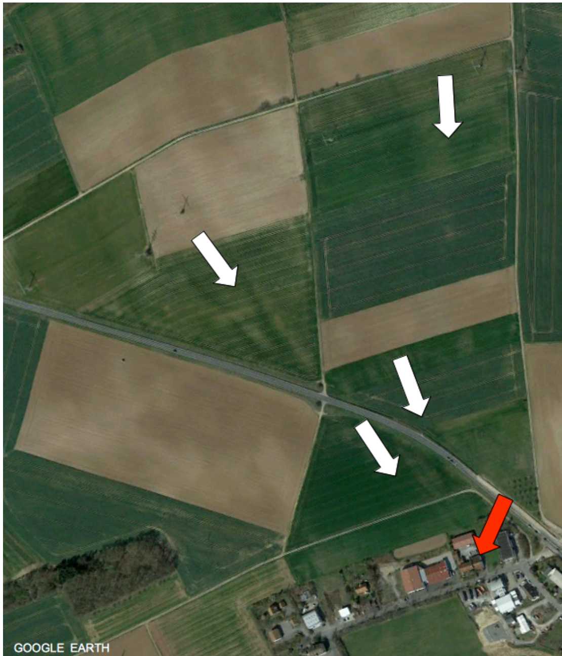
Abb. 36. Die Lage des betroffenen Hauses (roter Pfeil) in einer bereits fotografisch erkenntlichen breiten geologisch-tektonischen Störungszone (weiße Pfeile) mit Verwerfungen und Subrosion (Karst-Lösung, Feinkornausspülung). Bei solchen Luftbildern ist es sehr wichtig, zu welcher Jahreszeit und in welcher Vegetationsperiode die Aufnahme gemacht wurde. Im ungünstigen Fall der Bodenfarben sieht man überhaupt nichts, zu günstigen Zeit sehr viel, wie hier ersichtlich. Das Digitale Geländemodell ist davon nicht betroffen, da es von der Vegetation überhaupt nicht beeinflusst wird (siehe die folgenden Bilder).
