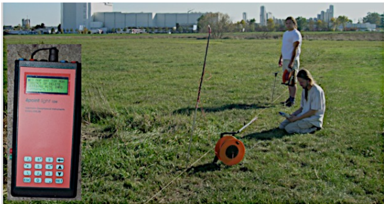
Abb. 27. Geoelektrische Widerstandsmessungen - Electrical Imaging. Einschub das Messgerät LIPPMANN 4point 10W für spektrale induzierte Polarisation mit acht Frequenzen.
