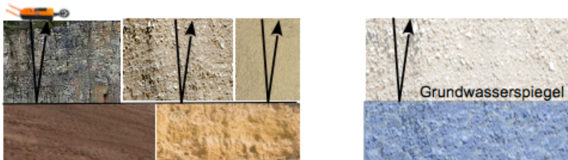
Abb. 9. Gute Radar-Reflexionen an Schichtgrenzen mit stark wechselnder Lithologie oder mit stark wechselndem Wassergehalt. Feucht und trocken, luftgefüllt - die Grenzflächenwellen (Stoneley-Wellen bzw. Scholte-Wellen) beim Bodenradar werden im nächsten Abschnitt erläutert.
