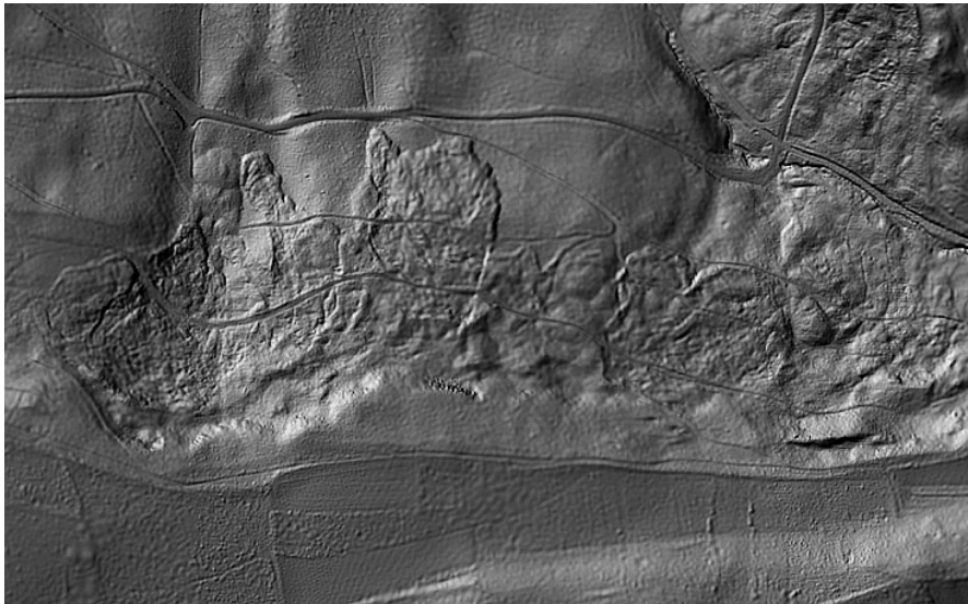
Abb. 31. Digitales Geländemodell DGM 1 im dichtesten Wald: Die Schummerungskarte zeigt einen Hangrutsch mit intensiven Fließstrukturen - Lehrbeispiel für jedes Ingenieurbüro.
